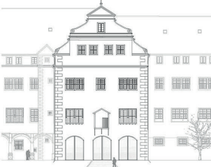
Austausch der Tore gegen Fenster mit One-Way Vision und Plasterung der Renaissance-Treppe
